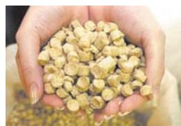
нию по переработке отходов древесины в пеллеты. Гранулы диаметром 6–8 мм сжигаются в твёрдотопливных и специальных (пеллетных) котлах, подача топлива в котёл автоматизирована. Калорийность древесных пеллет вдвое выше, чем у обычных дров.
